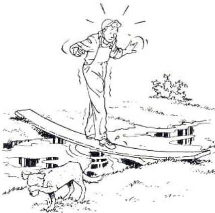
Plank die niet voldoende stijf is.
